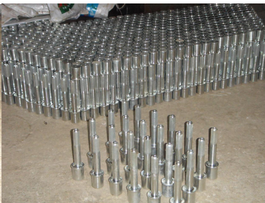
案例图 2：快速公交(BRT)安全门联轴杆
